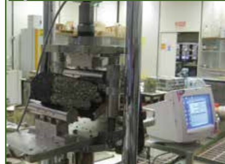
Figura 4. Sistema statico flessionale
