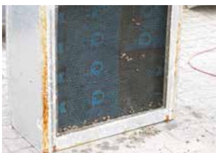
9. Faccia inferiore di DEFEND ANTIRADICE inalterata dopo il test
