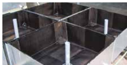
2. Vasche di prova impermeabilizzate
